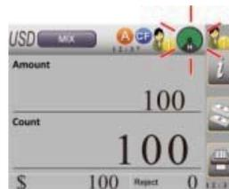
2. В правом верхнем углу LCD-дисплея последовательно отображаются 3 варианта скорости счета.
