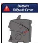
Сбой в нижнем проводящем тракте, пожалуйста, откройте его и проверьте на наличие посторонних предметов.
