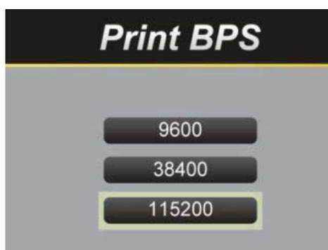
4. Выберите скорость передачи данных подключенного термопринтера.
