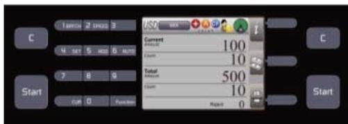
1. Два комплекта клавиш «**C**» и «**START**» для работы в режиме эксплуатации двумя пользователями.
