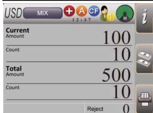
2. Текущий результат подсчета отображается в верхней части экрана.
