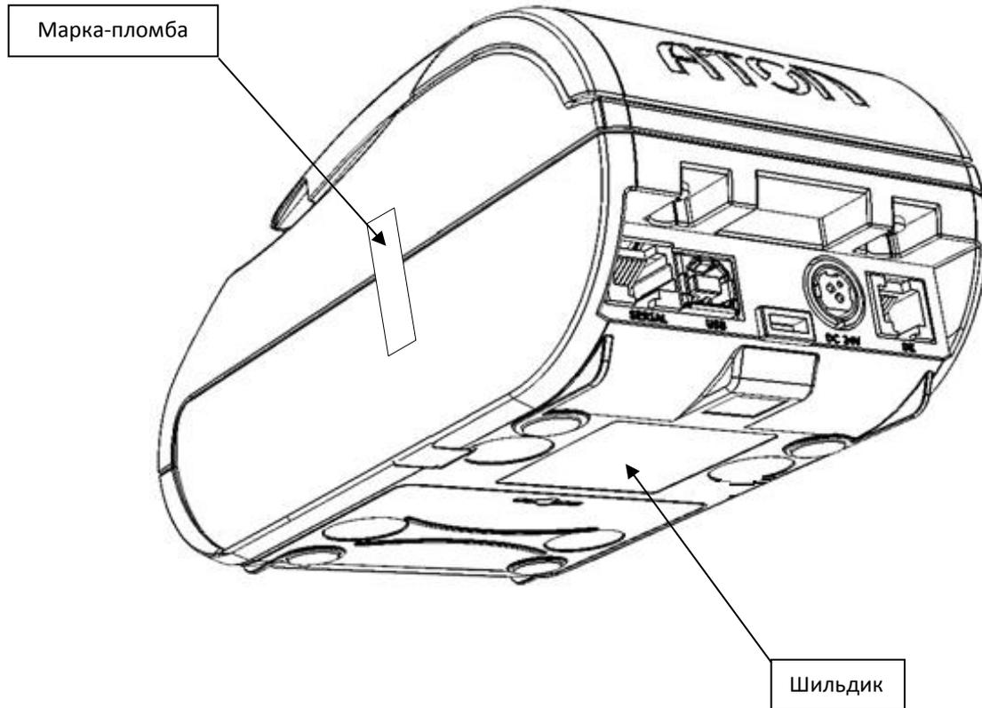
Один элемент марки-пломбы наклеивается на кожух, закрывающий блок управления и устройства печати кассовых чеков так, чтобы было невозможно получить доступ к внутренней части ККТ без разрушения марки-пломбы. Шильдик наклеивается на дно корпуса ККТ.
