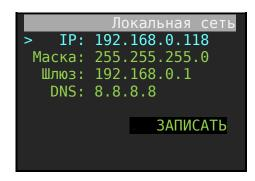
После записи параметров включите кабель Ethernet в разъем ККТ.
