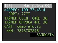
Внимание! Если планируется использовать ККТ «Пионер-114Ф» в автономном режиме, то значение ИНН ОФД следует установить все нули. Пример: 0000000000 (десять разрядов).
